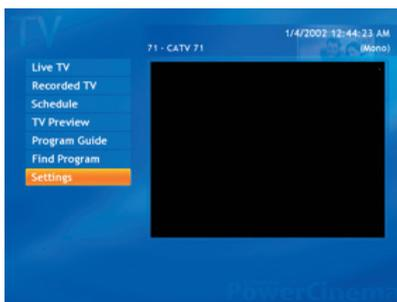
2. Sélectionnez **Signal Settings** (Paramètres du signal) dans la page TV settings, puis pressez **OK**.
